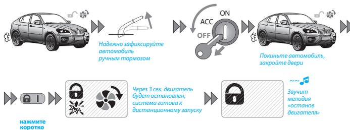
В случае если предполагается использовать дистанционный или автоматический запуск двигателя на автомобиле с МКПП, то перед постановкой автомобиля на охрану необходимо выполнить следующую последовательность действий:
