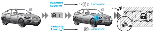
Для того чтобы облегчить поиск своего автомобиля на крупной автостоянке, коротко нажмите на кнопку **(A I)** во время, когда автомобиль находится под охраной, система выдает 5-кратный звуковой сигнал сирены и пять вспышек указателей поворота.
