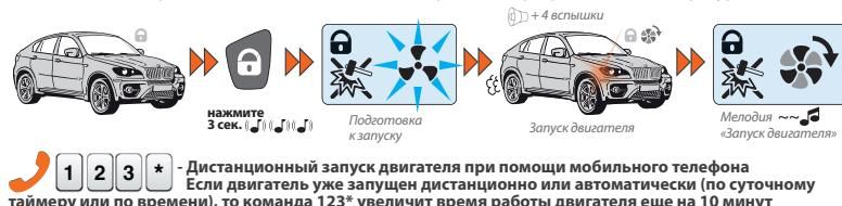
Для дистанционного останова двигателя, находящегося в режиме прогрева, необходимо нажать и удерживать кнопку брелока в течение двух и более секунд. Двигатель будет немедленно остановлен, что подтвердит мелодия «ДВИГАТЕЛЬ ОСТАНОВЛЕН» и погасшая пиктограмма
