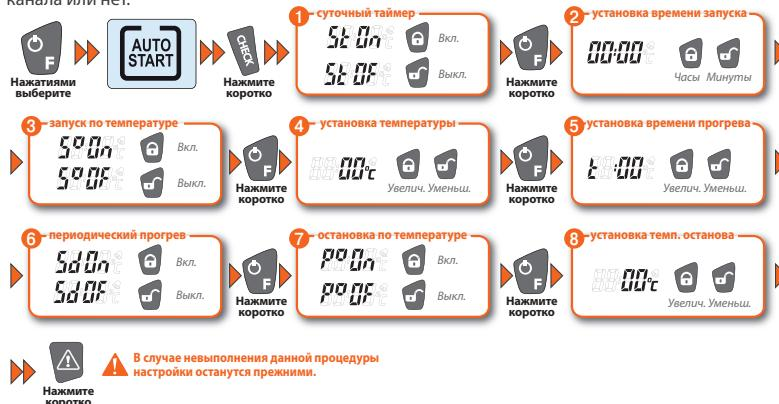
Программирование режимов автоматического запуска и условий работы двигателя производится на брелоке с ЖК-дисплеем. Для программирования данных режимов нажатиями на кнопку выберите пиктограмму **AUTO START**, нажмите на кнопку . Вы находитесь в меню функций автоматического старта. Меню имеет восемь подуровней, перемещение между которыми производится нажатиями кнопки . Изменение значения подуровня производится кнопками и .
