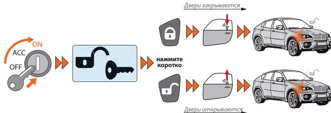
Запирание и отпирание дверей можно производить принудительно с брелока без постановки на охрану при включенном зажигании. Для этого при включенном зажигании коротко нажмите кнопку - двери при этом закроются, а нажатие кнопки откроет замки дверей.
