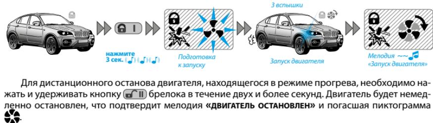
Для дистанционного останова двигателя, находящегося в режиме прогрева, необходимо нажать и удерживать кнопку брелока в течение двух и более секунд. Двигатель будет немедленно остановлен, что подтвердит мелодия «ДВИГАТЕЛЬ ОСТАНОВЛЕН» и погасшая пиктограмма .
