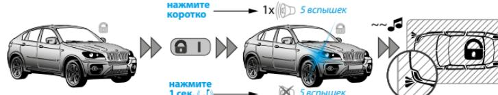
Для того чтобы облегчить поиск своего автомобиля на крупной автостоянке, коротко нажмите на кнопку во время, когда автомобиль находится под охраной, система выдаст 5-кратный звуковой сигнал сирены и пять вспышек указателей поворота.
