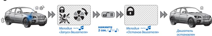
За одну минуту до штатной остановки двигателя на брелок придет оповещение, замигает пиктограмма и каждые 10 сек. будет звучать мелодия «ОСТАНОВ ДВИГАТЕЛЯ ЧЕРЕЗ 1 МИН.»
