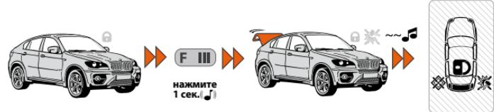
Если система находится под охраной, то одновременно с открытием замка багажника из контура охраны исключается зона багажника и отключается шок-сенсор и доп. датчик, все остальные зоны остаются под охраной.
