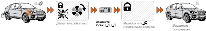
За одни минуту до штатной остановки двигателя на брелок придет оповещение, замигает пиктограмма и каждые 10 сек. будет звучать мелодия «ОСТАНОВ ДВИГАТЕЛЯ ЧЕРЕЗ 1 МИН.»
