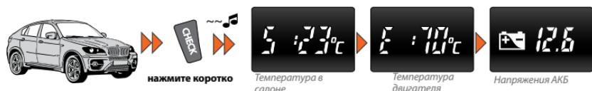
Для получения информации о температуре двигателя или салона и напряжение аккумулятора нажмите коротко на кнопку . В течение 10 сек. индикатор будет попеременно показывать температуру в салоне (), температуру двигателя () и напряжение аккумуляторной батареи (). Для выхода из режима коротко нажмите кнопку или выход произойдет автоматически через 10 сек.
